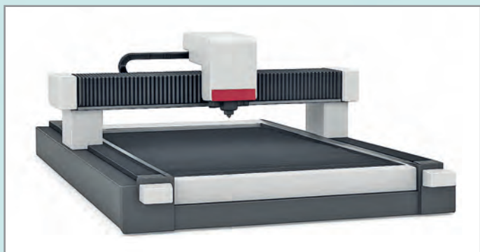
Crémaillères dans les lasers à lit plat – idéales pour une vitesse de coupe élevée et un fonctionnement silencieux.
