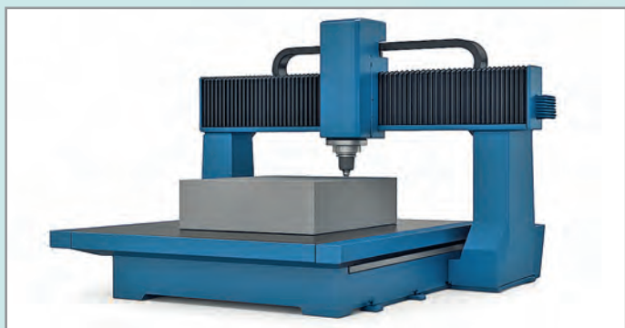
Entraînement à crémaillère dans une fraiseuse à portique – force d’avance élevée et positionnement précis pour les pièces lourdes.
