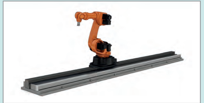
Robotlar için kullanılan doğrusal hareket eksenleri, yüksek yük kapasitesiyle genişletilmiş bir çalışma alanı sağlar.
