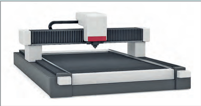
Düz yataklı lazerlerdeki kremayer ve pinyon dişliler – yüksek kesme hızları ve sorunsuz çalışma için idealdir.
